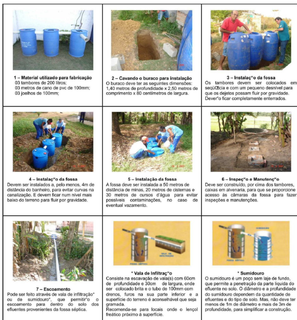
Figura 17: Modelo de fossa séptica econômica Fonte: AGB Peixe Vivo (2012)
